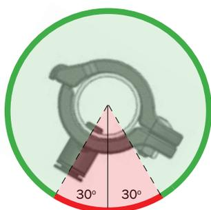
**ВНИМАНИЕ:** Для предотвращения образования осадка в клапанах, рекомендуется устанавливать соединитель шланга под углом примерно  $30^\circ$ .
