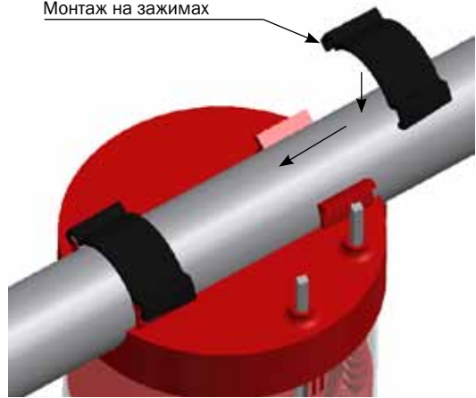
Монтаж на зажимах
