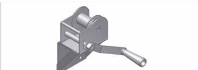
Ручной ролик монтируется к стене и применяется для пуска/остановки дозатора.
