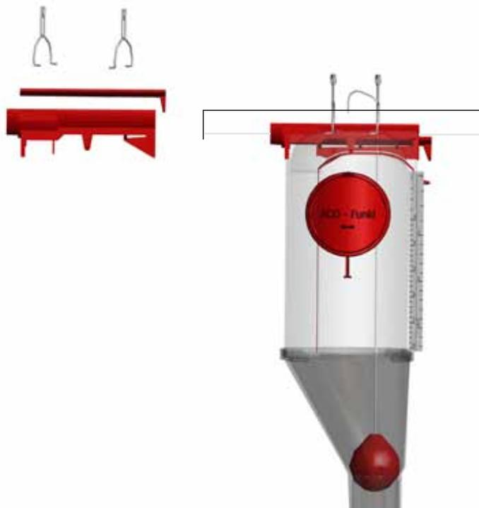
Место для дозатора помечается на транспортере. Просверливаются отверстия с соответсвии с монтажным листом M-1107.
