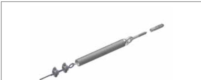
В каждом ряду монтируется пружина для поддержания системы в натянутом положении.
