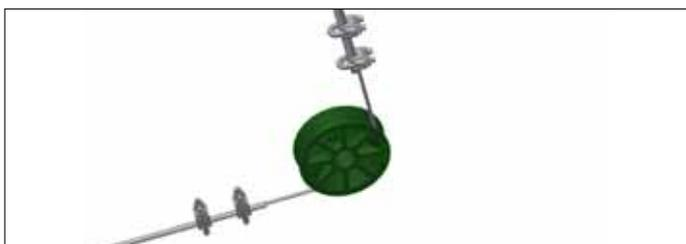
При переходе между проводом и оцинк. пружиной применяется 2 шт. проводов блокировки для сборки.
