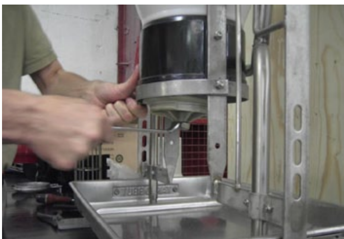
Снимите стопорную гайку 8 мм и выкрутите кормовую пластину (влево).
