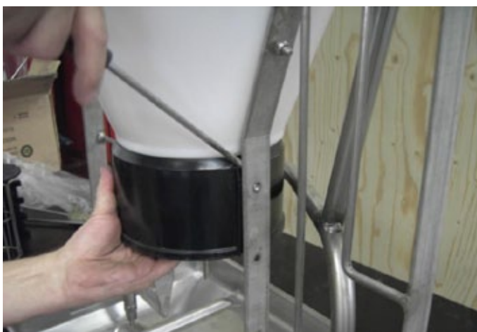
Снимите гайку 8 мм и вдавите болты вовнутрь. Затем освободите рукав как показано на рисунке при помощи большой плоской отвертки. Как альтернатива - выбейте болты при помощи молотка.
