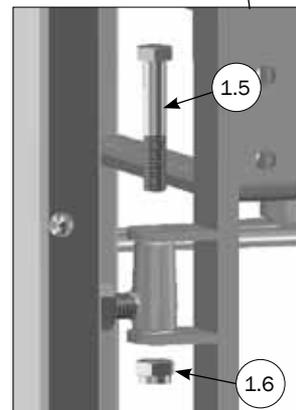
Для монтажа на передних трубах используется только 2 шт. "Крепление к стене".
