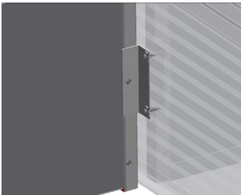
Крепление для перегородки к ПВХ панели - двойное
