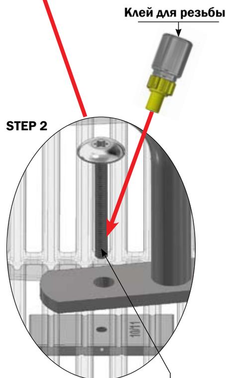
Клей для резьбы арт. № 29100067 **должен** применяться к винту, когда винт устанавливается на болтовом соединении, и винт **должен** также быть затянут потом гайкой с пружинкой. Функция затвердевания 3 часа, полное затвердевание - 8 часов.
