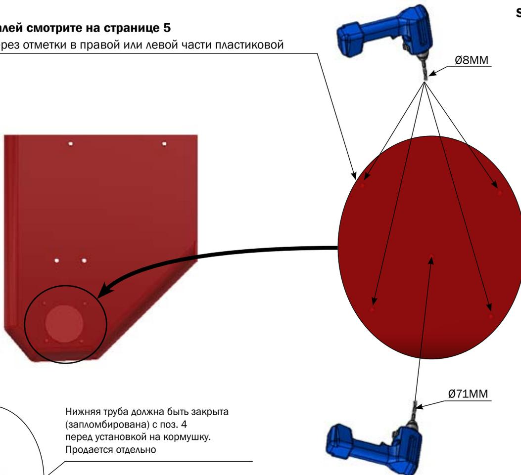
Нижняя труба должна быть закрыта (запломбирована) с поз. 4 перед установкой на кормушку. Продается отдельно
