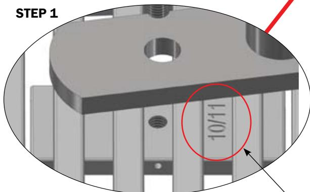
Фитинг с болтовым креплением установлен правильно, если 10/11 железных решеток и маркировка 10/11 на кронштейне обращена против решетки, и то же самое для железных решеток 12/13.
