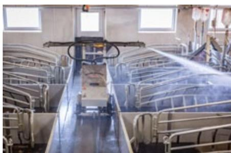
ProCleaner X100 может быть запрограммирован так, чтобы запустить программу замачивания и несколько различных видов мойки. Робот подключается через существующую систему высокого давления с помощью стандартных шлангов высокого давления и требует напора воды, по крайней мере, 25 литров в минуту.
