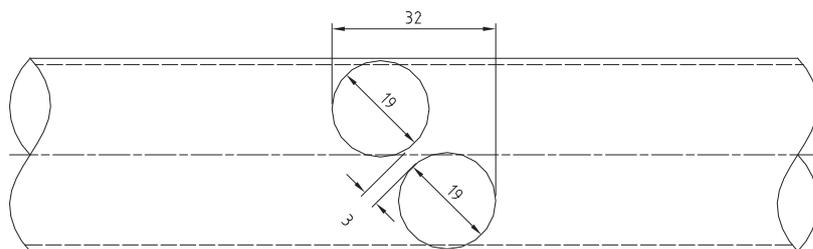
Для получения оптимального опорожнения труб конвейера, сверлятся по 2 отверстия при каждом выходе. Отверстия сверлятся по диагонали друг от друга.
