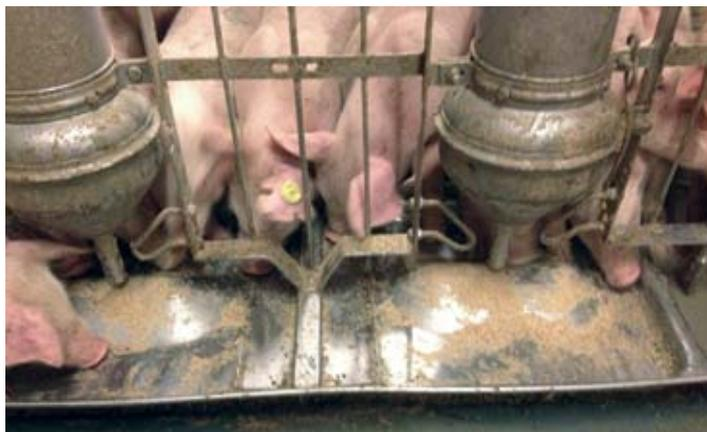
Двойной FUNKIMAT полностью сделан из нержавеющей материалов, что обеспечивает ему долгий срок службы. Двойной FUNKIMAT сконструирован с учетом действующих требований, легко поддается чистке и совершенно водонепроницаем при разбрызгивании. Автомат может быть настроен для любого вида корма, а также есть возможность совсем перекрыть поступление корма. Автомат можно разобрать для опустошения и чистки.
