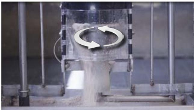
Рис. Смешивание корма 1. Автоматическая подача корма при определении сенсором, когда корыто пустое.
