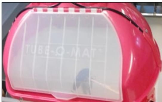
Прозрачная часть крышки расположена так, чтобы ее можно было легко открыть и проверить кормовой автомат вручную. Благодаря прозрачному материалу бункера, количество корма можно контролировать с расстояния.
