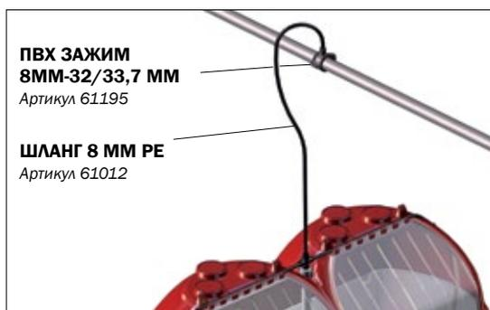
Для подачи воды предусмотрены гибкие шланги, которые закрепляются на крышке бункера. Шланги можно пропустить вдоль вертикальных кормовых труб, чтобы внутри станка было как можно меньше частей. Таким образом упрощается и ускоряется монтаж кормовых автоматов.
