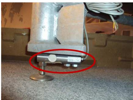
Весовые датчики расположены на ножках танка. Другими словами – танк и есть весовая чаша. Вес отображается на компьютере.
