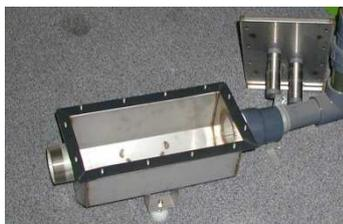
При прохождении потока корма из смесительного танка через камнеуловитель, мелкие камни оседают на дне, а встроенный магнит притягивает возможные металлические частицы, что обеспечивает дополнительную защиту насоса.
