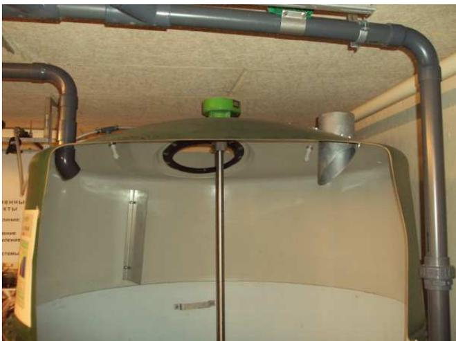
Независимо от того, сколько у вас компонентов (соответственно бункеров), компоненты поступают из бункеров в смесительный танк по общей трубе. Шнековые транспортеры, идущие из-под бункеров подсоединяются к одной общей трубе, которая в свою очередь присоединяется к верхней части смесительного танка. Компьютер дает команду шнековой системе транспортировки корма из какого бункера (какой компонент) требуется забрать
